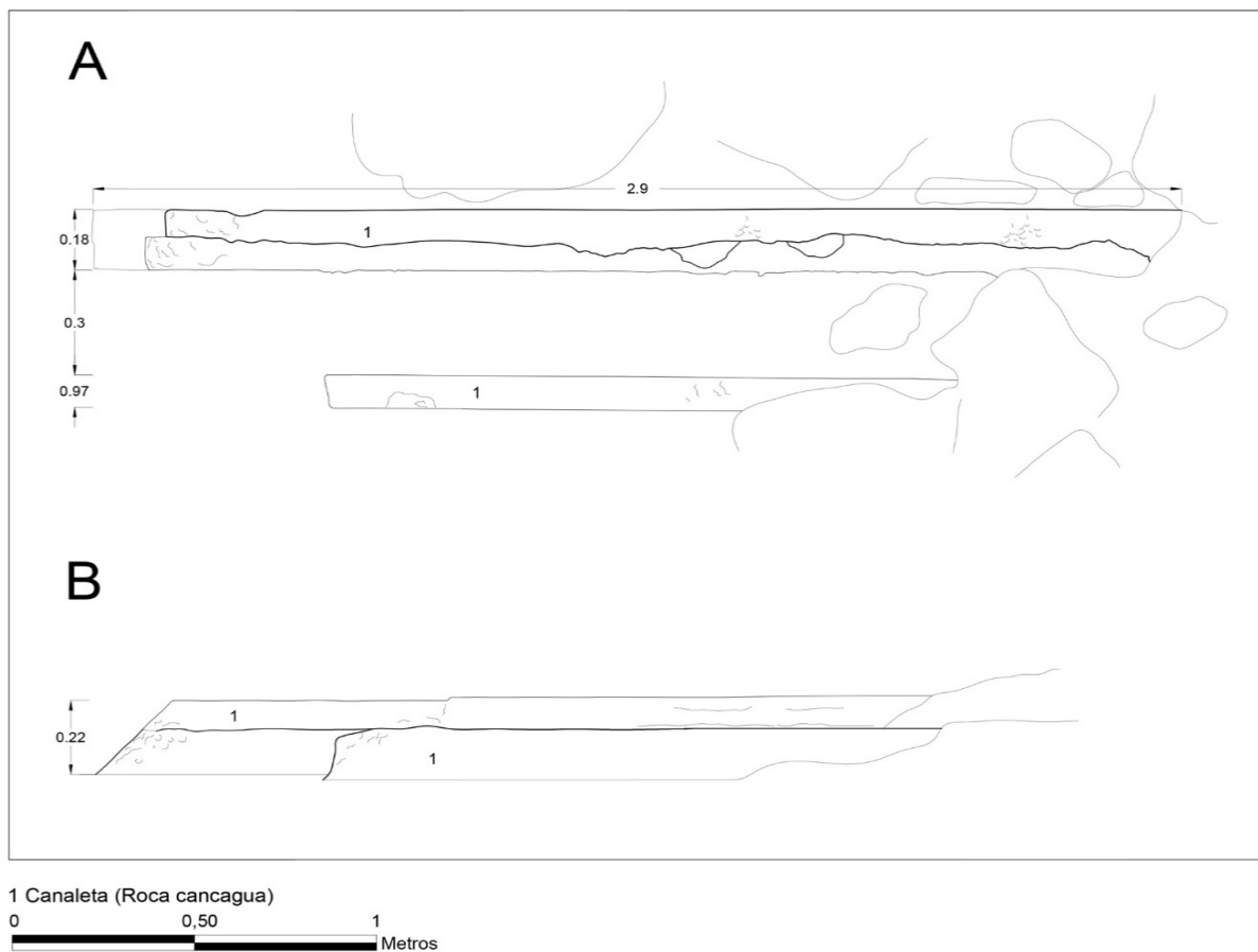
Figura 4. Planta (A) y elevación (B) del Rasgo 5. Los elementos constructivos que configuran el rasgo, corresponden a 2 muros rectos paralelos que conforman la canaleta (1).
